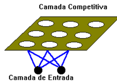
Figura 6 – Esquema básico de um modelo de Kohonen
