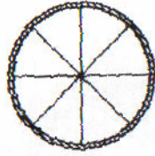
Figura 26 - Supressor de modos com campos elétricos em guias radiais, constituído por fios metálicos dispostos numa seção transversal do guia
