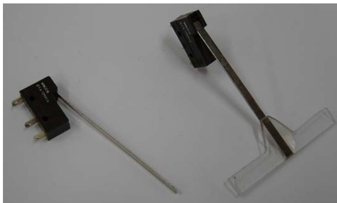
Figura 13 – Foto dos sensores de contato utilizados para detectar a colisão.
