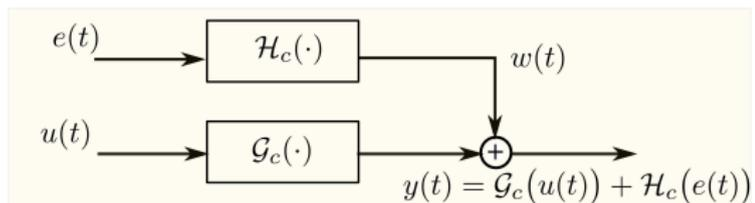
FIGURA: Sistema com entrada  $u(t)$  e ruído aditivo de medida  $w(t)$ .
