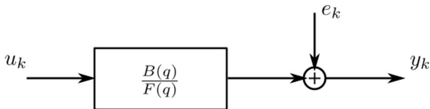
FIGURA: Diagrama de blocos da família de modelos OE
