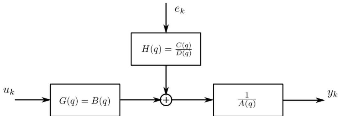
FIGURA: Diagrama de blocos da família de modelos ARARMAX
