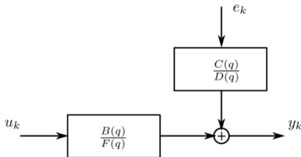
FIGURA: Diagrama de blocos do modelo BJ
