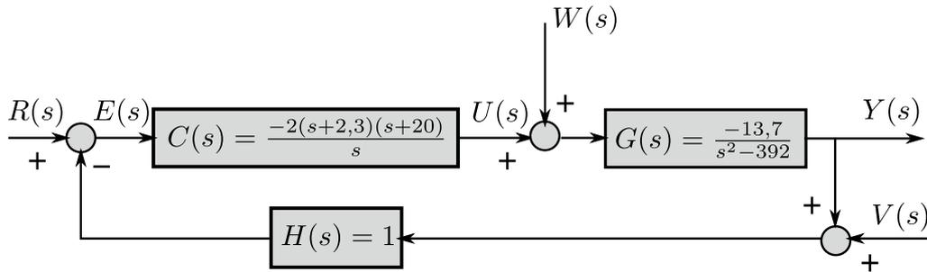
Figura 3: Diagrama de blocos do sistema do eletroímã linearizado.
