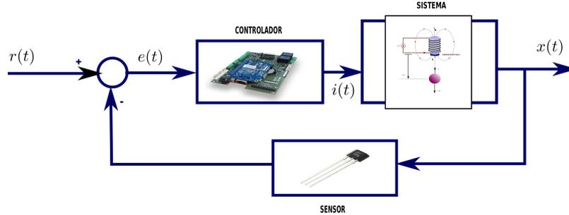
Figura 2: Diagrama de sinais e elementos que compõem um sistema de um eletroímã.
