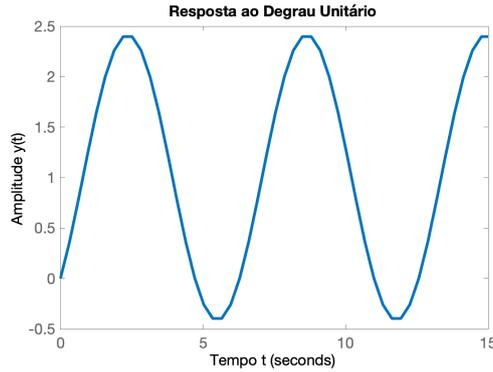
Figura 2: Resposta ao degrau do sistema com  $K = -1$ .
