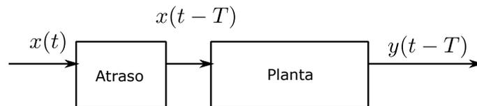
Figura 1: Exemplo de diagrama de blocos de um sistema contendo atraso de transporte.
