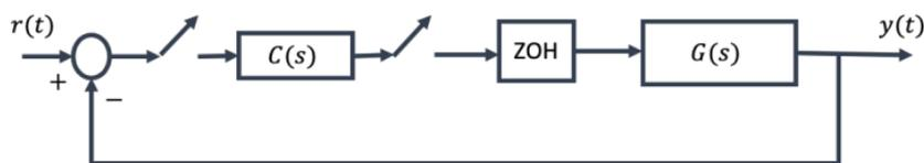
em que a planta corresponde a um sistema do tipo  $G(s) = 1/(s + 5)$ . Deseja-se projetar um controlador digital em cascata que faça o sistema operar com erro nulo a entrada degrau unitário, com tempo de estabilização de  $10/3$  s e máximo overshoot de 10%. O tempo de amostragem do sistema é de 0,5 s.
