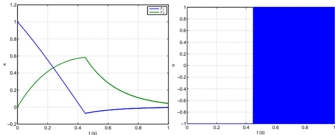
Nota-se intenso chaveamento no sinal de controle à medida em que o estado se aproxima da origem. Em uma implementação prática, esse efeito pode ser indesejável. Uma forma de lidar com isso seria suavizar o controle em uma vizinhança admissível da origem.
