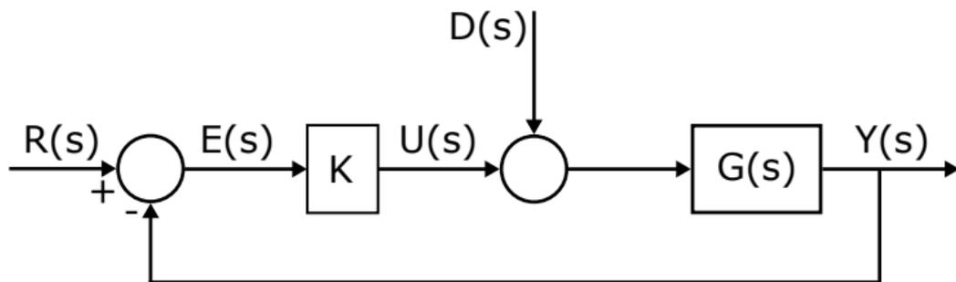
A função de transferência  $T_{d,MF}(s)$  entre a perturbação e a saída é dada por:
